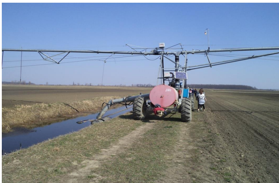
Slika 3.10.3. Opskrba vodom Lineara s dva kišna krila i na dvije proizvodne površine
